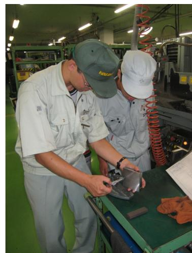
平面研削盤加工品の寸法測定
